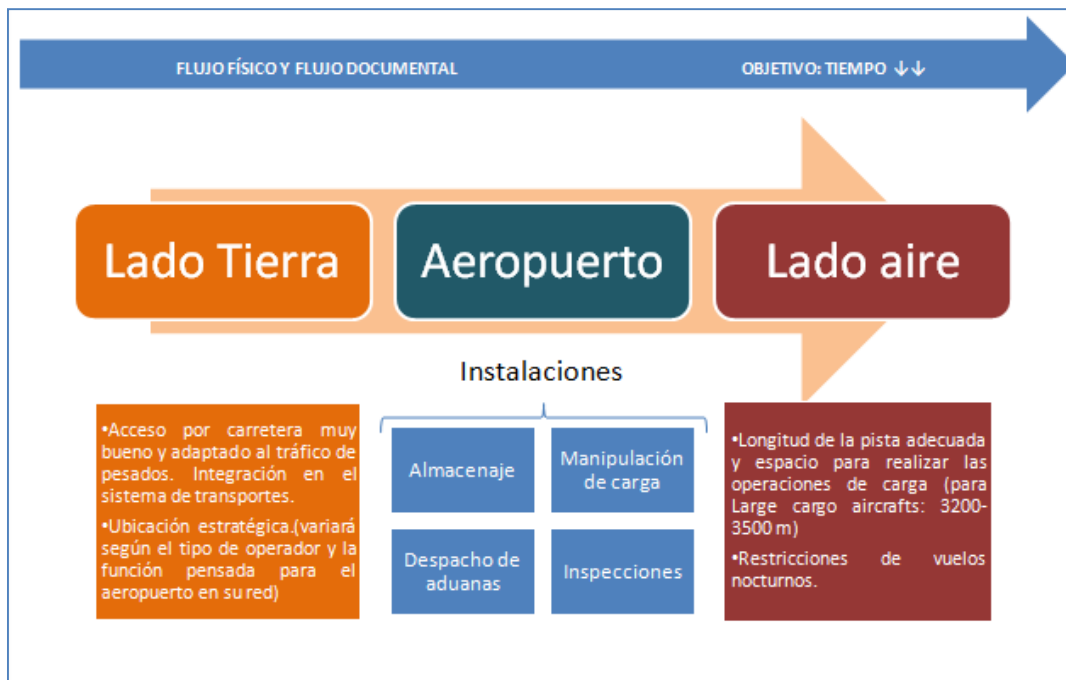
Ilustración 10.- Zonas del aeropuerto donde tenemos que focalizar nuestra atención a la hora de estudiar la infraestructura existente.
